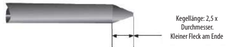
Bei Inverter-gesteuerten AC&DC-Maschinen verwenden Sie eine Wolframelektrode mit einer Kegellänge, die etwa dem 2,5-fachen der Wolframlänge entspricht
