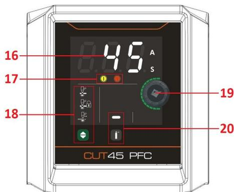
16. Zone d'affichage des paramètres et des codes d'erreur
