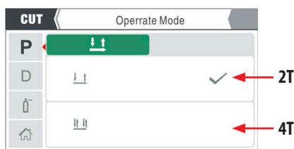
En mode "Coupe continue", appuyez sur la molette de commande pour accéder aux options de l'icône sur la gauche et faites défiler jusqu'à "P" et appuyez à nouveau sur la molette de commande. De là, vous pouvez sélectionner 2T ou 4T.
