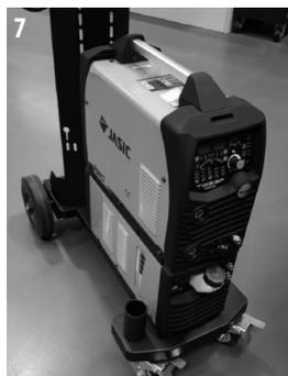
8. Retirez les supports supérieurs illustrés à l'article 2 et installez-les sur le dessus de la source d'alimentation comme illustré ci-dessous. Utilisez les vis que vous avez retirées du couvercle de la source d'alimentation pour fixer les deux supports en place.
